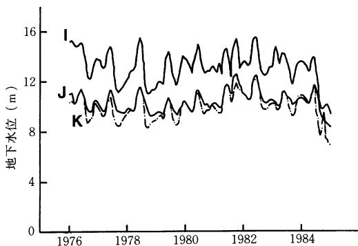
図11 豊平川扇状地（扇端）における地下水位の経年変化（道開発局石狩川開発建設部の資料より引用）
